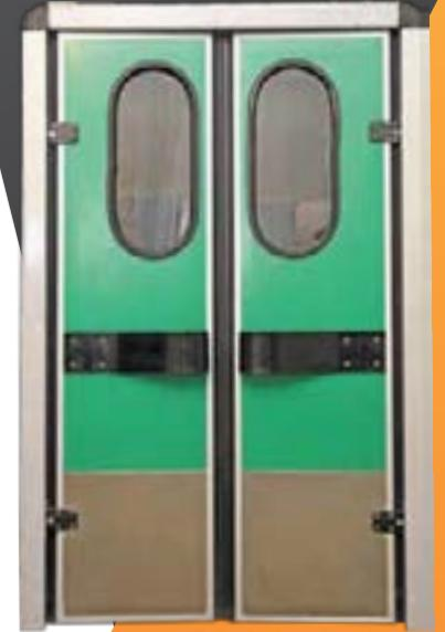
Ce sont les portes dont l'épaisseur d'aile est **40 mms** avec plombage de polyurethan à fenêtre ou sans fenêtre et qu'on peut les monter sur le pannel ou le mur portant une seule ou deux ailes ouvrables **90 degré** par deux cotés ou bien ouvertes permanent et qui pourront être employées pour les passages de service. Elles sont fabriquées en injectant polyurethan de la densité **40 kgs / m<sup>3</sup> (+2)** entre deux tôles et sans empoyer de bois.
